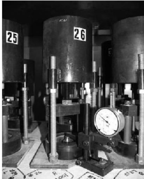
圖25 拉伸潛變試驗設備圖例
