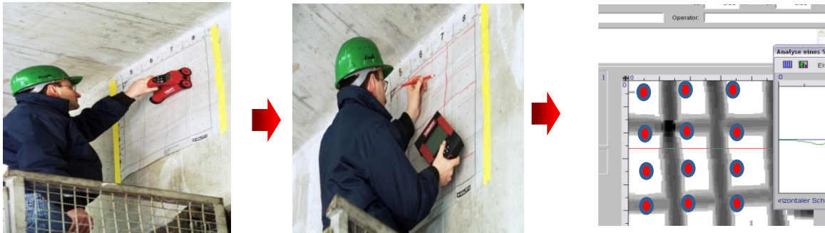
圖29 鋼筋探測流程範例
